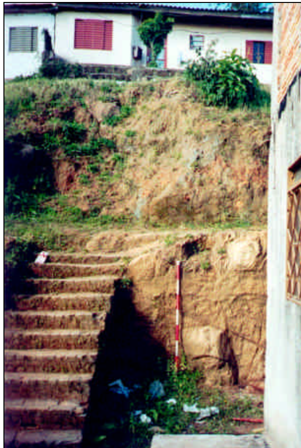
Foto 20: Estaca 0+180 . Perfil de ocorrência padrão. Solo saprolítico com matacões de tamanho variável sobre. Saprolito de rocha granítica ou rocha alterada.
