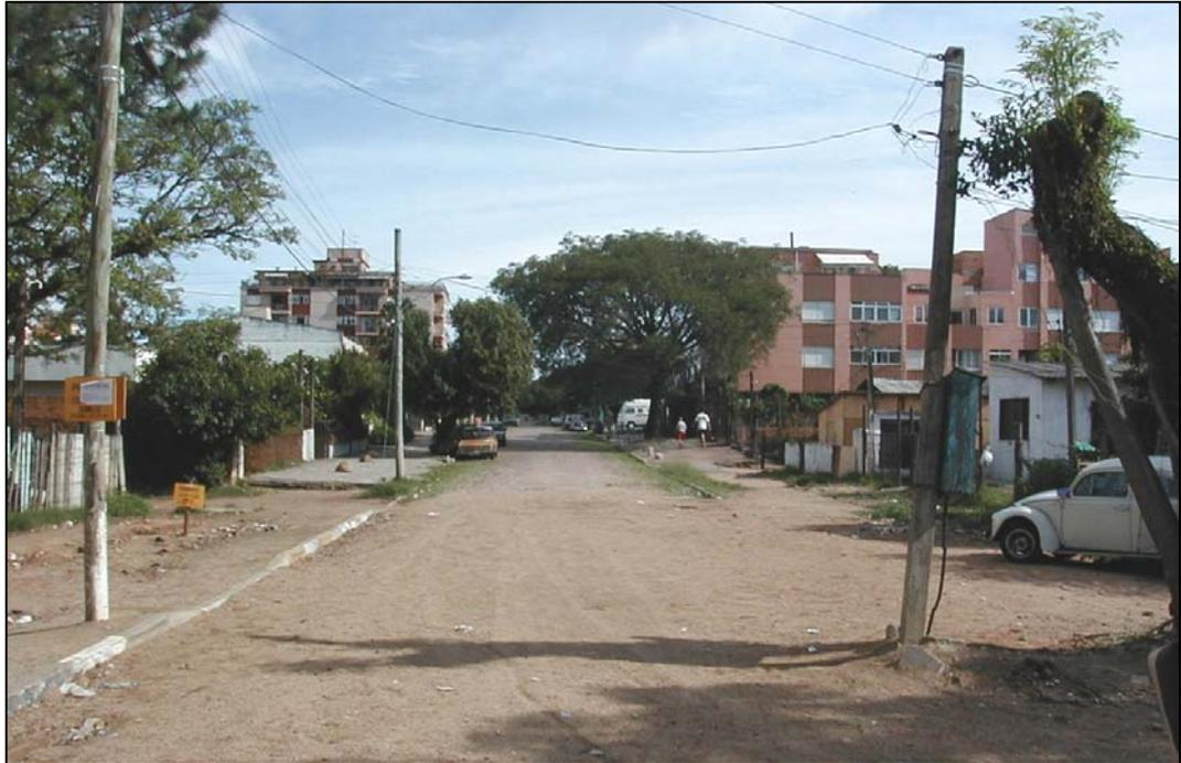
Foto 03 – Vista da Rua Jataí, sentido fim-início (contrário ao estacionamento). Destaca-se a existência de poste a ser removido, em frente a casa nº 175 (lado esquerdo). Na foto, observa-se também a existência de meio-fios e calçamento com paralelepípedos no segmento da rua anterior.
