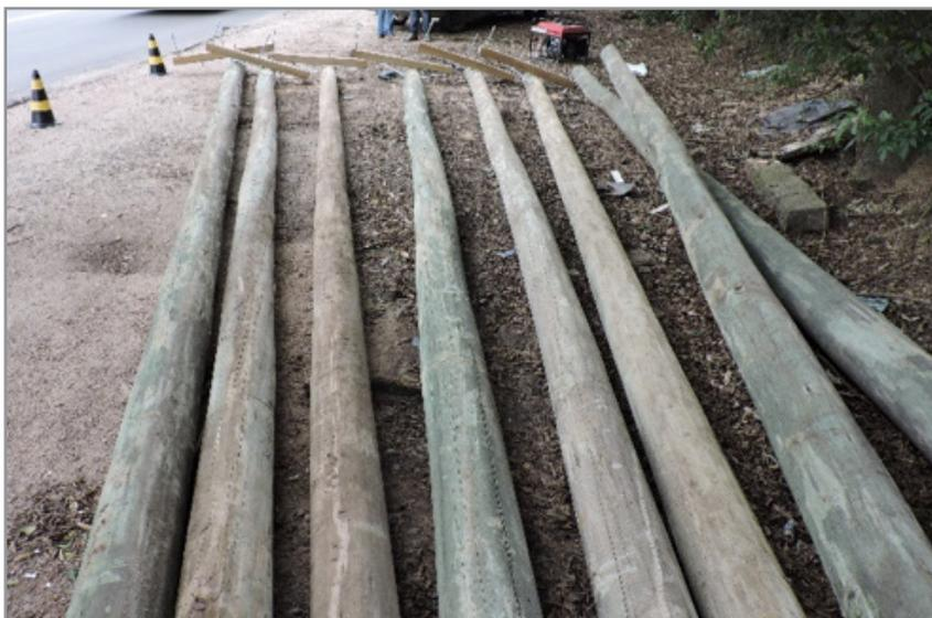
**Figura 24.** Postes de madeira de eucalipto.
