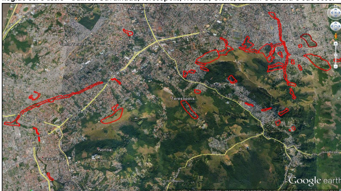
Figura 2: Região Sul e Leste os polígonos em vermelho mostram os 54 setores de risco alto e muito alto mapeados na etapa de campo que foi realizada no período de outubro de 2012 e junho de 2013.
