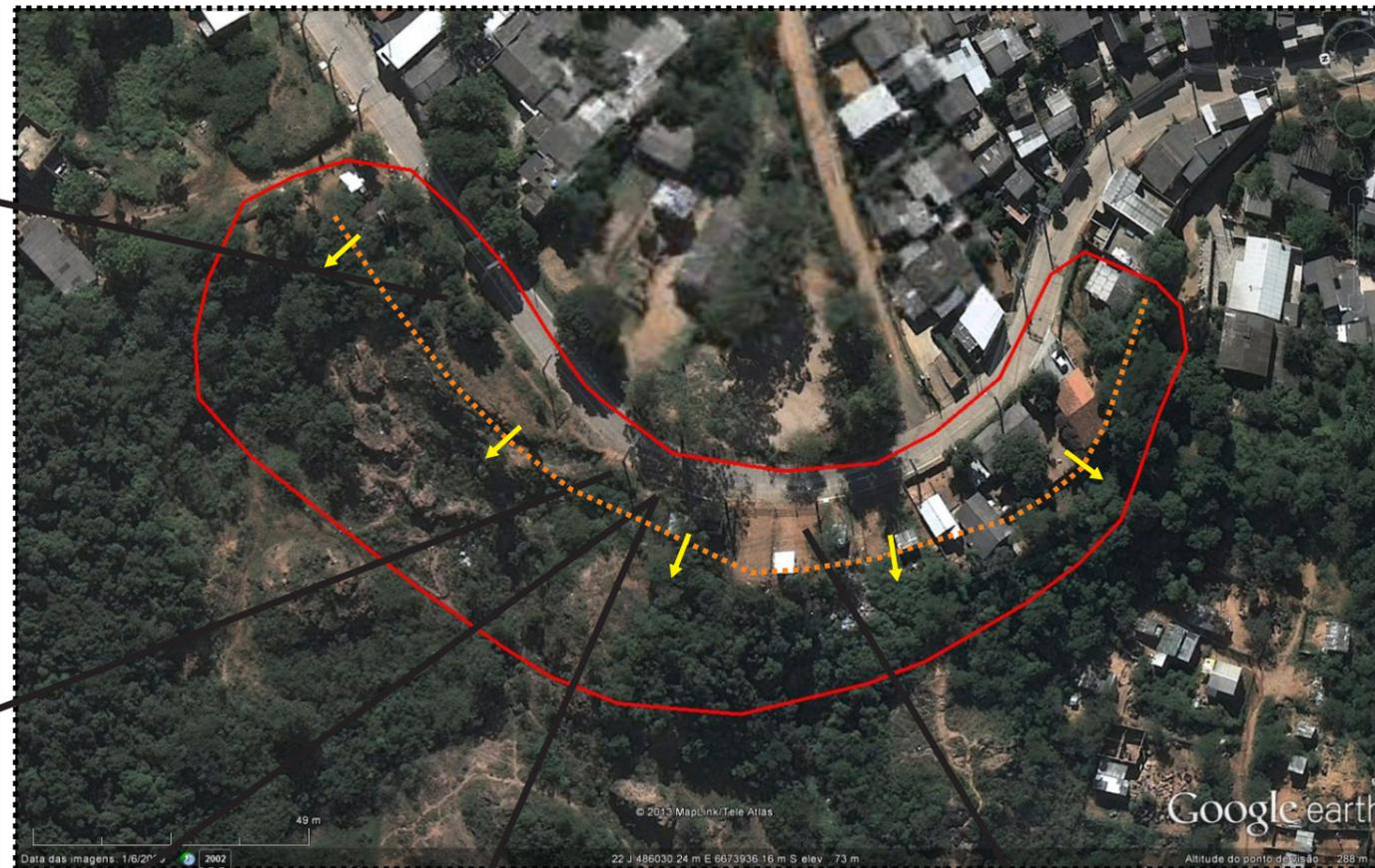
**Descrição:** Casas construídas rente a crista de talude de antiga pedreira de extração de material de empréstimo. Devido a proximidade da crista e por estarem construídas sobre aterro, o local está sujeito a ocorrência de deslizamento.
