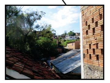
**Descrição:** Casas construídas em encosta de morro com alta declividade e, localmente, dentro do talvegue. Precariedade na condução das águas das chuvas e servidas saturando/erodindo o solo de forma generalizada. O setor apresenta alto risco para ocorrência de pequenos deslizamentos ocasionados pelo alto fluxo de água proveniente das nasceste e/ou provocados por solapamento de margem de drenagem que corta a área. Em chuvas torrenciais o local fica parcialmente inundado.
