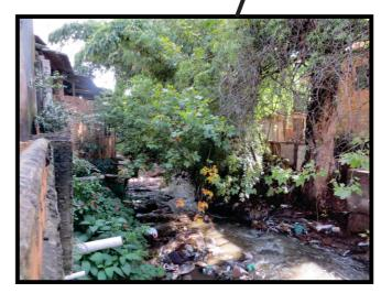
**Descrição:** Casas construídas nas margem de importante afluente do Arroio Dilúvio. Despejo de lixo no leito favorecem ao assoreamento do arroio. São observados pontos com solapamento de margem que pode provocar pequenos deslizamentos. São recorrentes eventos de inundação.
