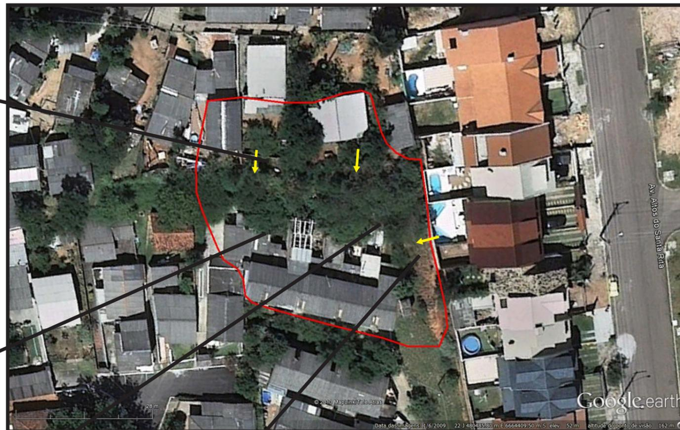
**Descrição:** Casas construídas rente a sopé de encosta. Encosta composta de material arenoso muito friável. No local ocorrem, frequentemente, deslizamentos que atingem o fundo das casas.
